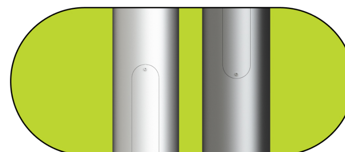
Конструкция вводного лючка алюминиевого комплекса KORN
